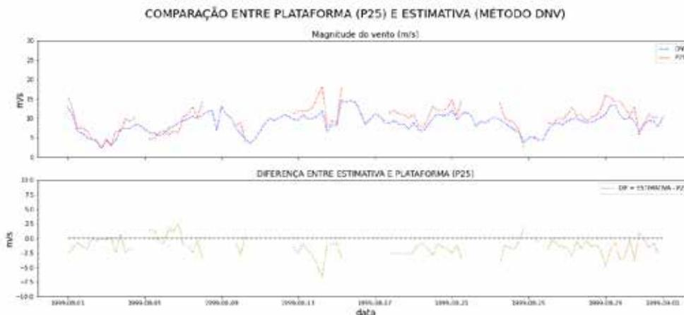
**Figura 8.** Magnitude do vento estimada pelo método da DNV e o vento da plataforma (P25) e a diferença entre as alturas significativas entre os dois.
