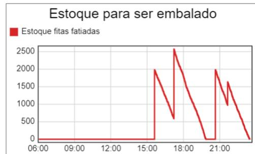
**Figure 14.** Intermediate Stock per machine - actual scenario
